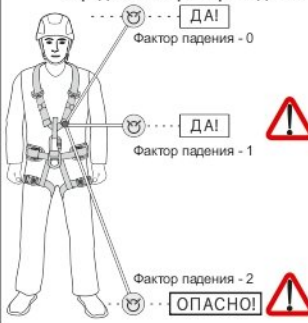
Рис. 7. Графическая схема к определению фактора падения
