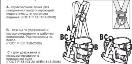
Рис. 2. Типы крепежных точек
