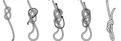
Рис. 3. Завязывание узла «восьмерка»
