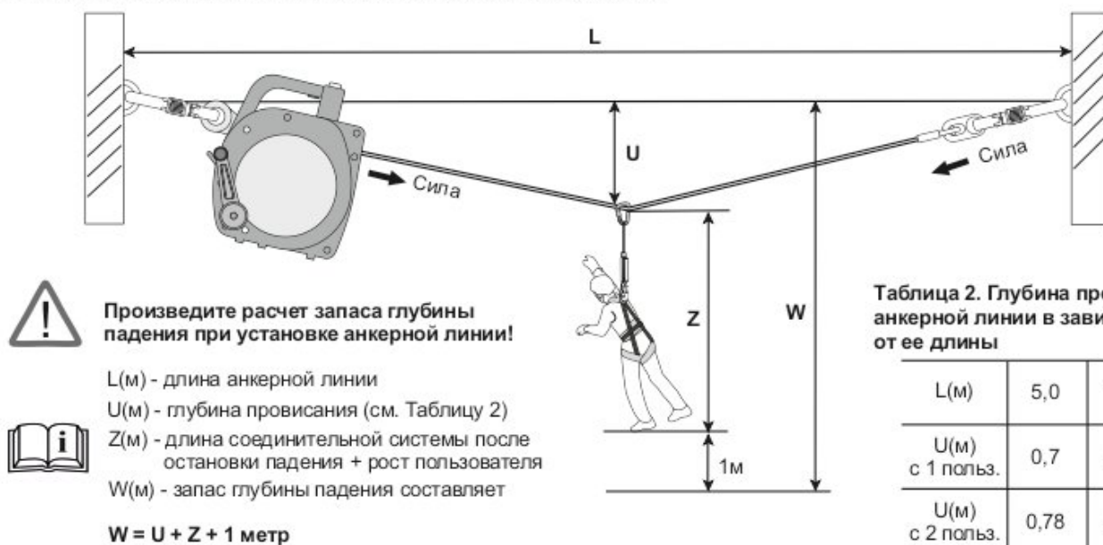
Рис. 7. Расчет запаса глубины падения при установке анкерной линии
