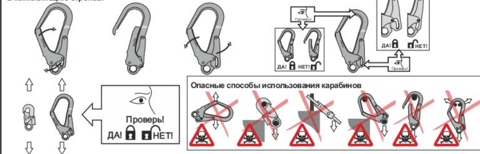
Рис. 6. Способы крепления стропов к анкерным устройствам
