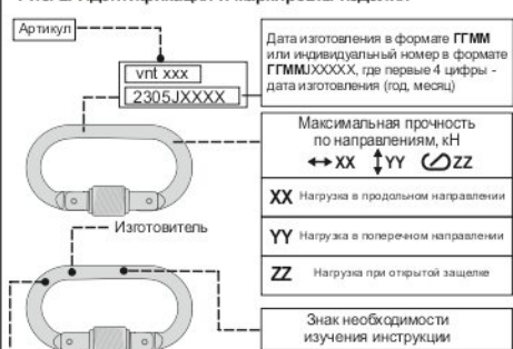
Рис. 2. Идентификация и маркировка изделия
