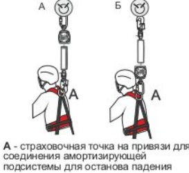
Рис. 5. Общие принципы использования карабинов
