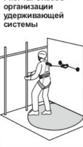
Рис. 12. Способ организации удерживающей системы
